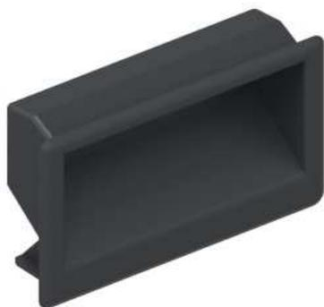
Ручки потайные для щитов 703.6 PF из стеклонаполненного полиамида. Материал ручки из полиамида ПА6, усиленные стеклянными шариками. Износоустойчивый материал с пониженным коэффициентом трения; может эксплуатироваться при низких и высоких температурах в пределах от:  $-60$  до  $+150$  °С; довольно продолжительная эксплуатация при высоких температурах, воздействии влаги и химических сред; устойчивость к щелочам, неагрессивным кислотам, солевым растворам.
